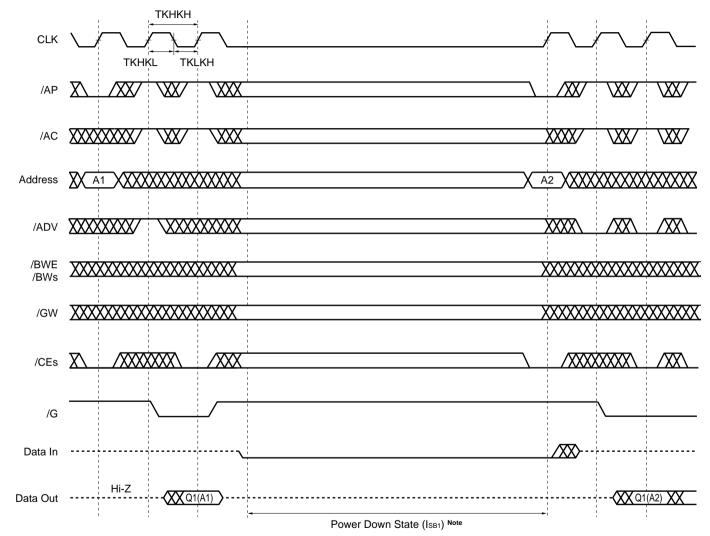
Note  $V_{IN} \le 0.2 \text{ V}$  or  $V_{IN} \ge V_{DD} - 0.2 \text{ V}$ ,  $V_{I/O} \le 0.2 \text{ V}$
